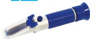
Tipo analogico professionale per la misurazione e il dosaggio della percentuale in massa di CLORURO di SODIO nell'acqua (salinità). Con sistema automatico di compensazione della temperatura ambientale.
